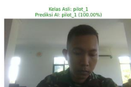
Gambar 6. Output pengujian inferensi real-time yang berhasil memverifikasi pilot utama terdaftar (Pilot 1) dengan skor kepercayaan 100%
