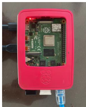
Gambar 9. Dokumentasi fisik perangkat Raspberry Pi 4 Model B yang digunakan untuk pengujian penerapan model TFLite
