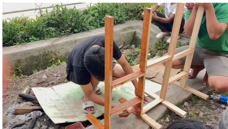
Gambar 5. Pembuatan rangka kayu sebagai penyangga sekaligus penyatu ketiga wadah
