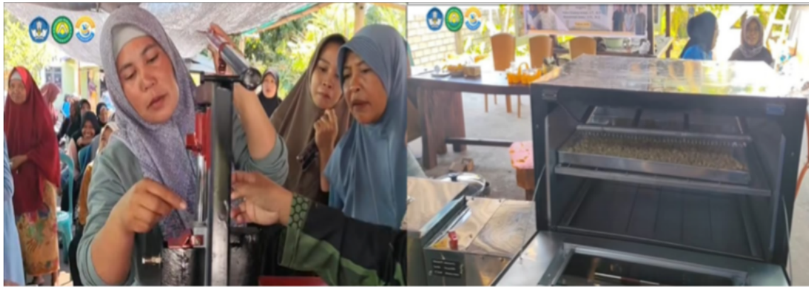
Gambar 3. Praktik pengolahan biji jambu mete menggunakan mesin pengupas
